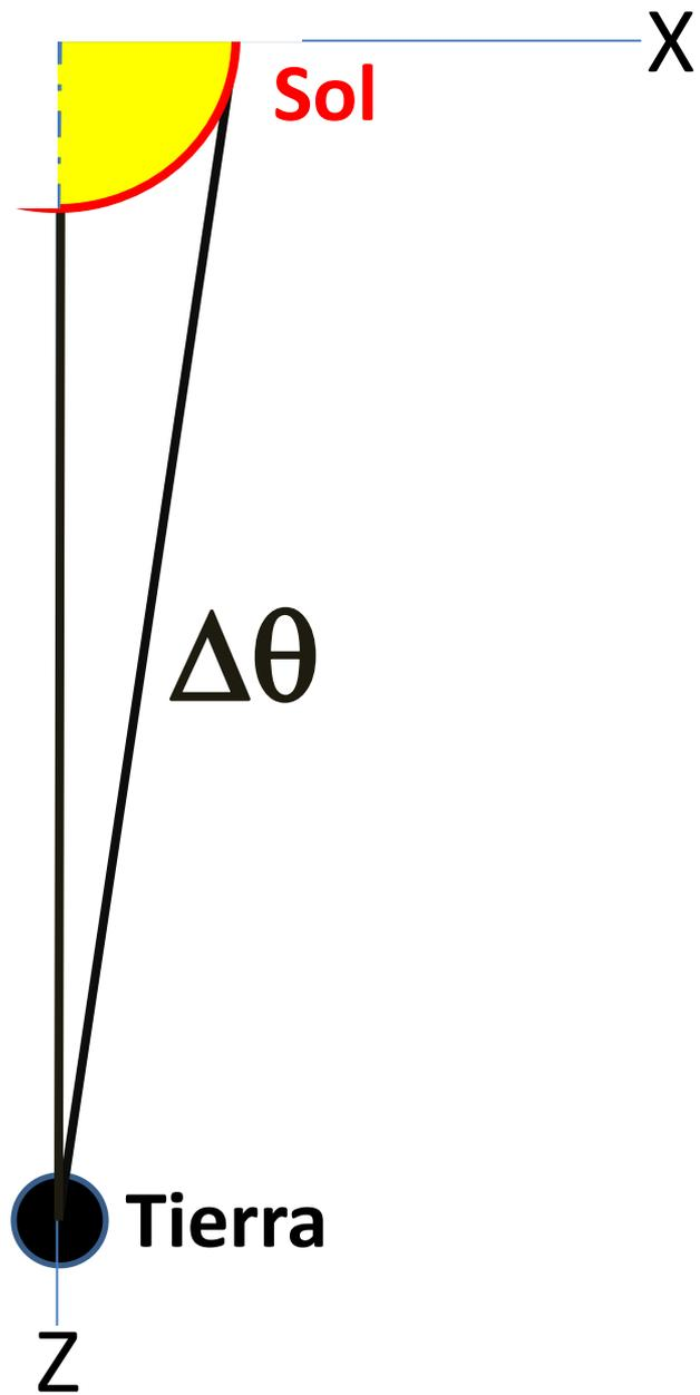
Dado que el Sol es un objeto extendido, la radiación que se recibe debe ser la paralela a la línea de visión, que es la dirección del vector unitario perpendicular al área receptora, por lo tanto, se introduce el factor  $\cos \theta$ . Visto desde el eje Z
